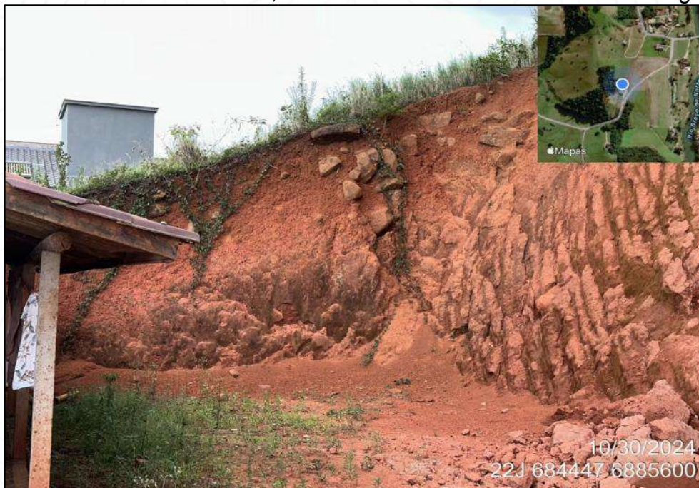
Figura 28 - Detalhe do corte em Saprólito de Diabásio, onde estão incrustados na massa de solo, blocos de diabásio em um solo mais argiloso.
