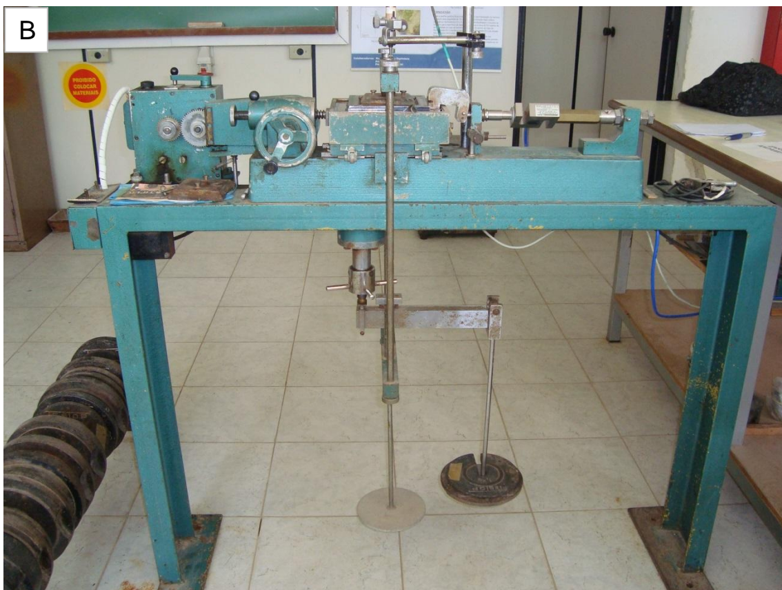
Figura 6. Equipamento para execução do ensaio de Cisalhamento Direto em campo (A) e em laboratório (B).
